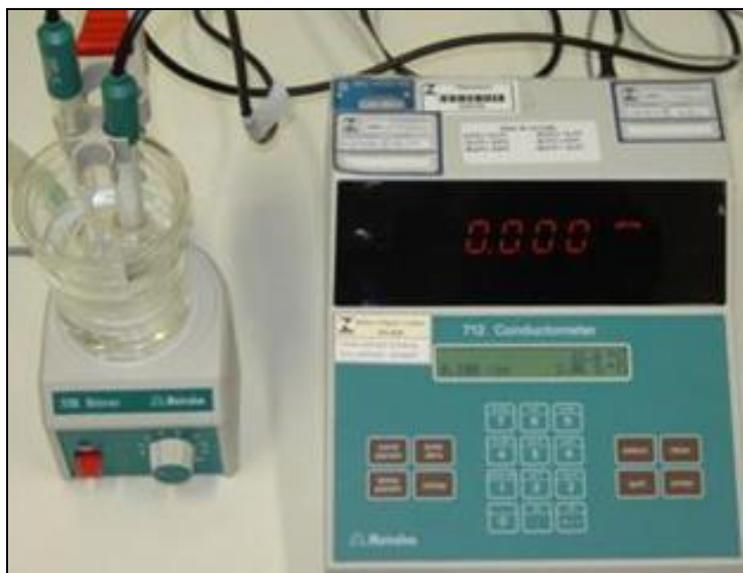
**Figura 16** - Medidor de condutividade eletrolítica utilizado nos estudos de homogeneidade e estabilidade.
