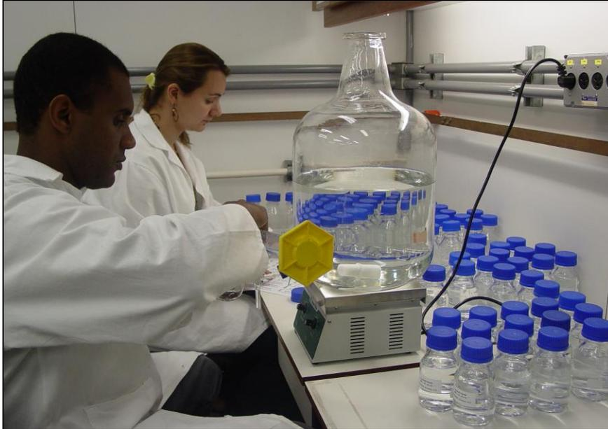
**Figura 12** - Envase da solução de  $5 \mu\text{S}\cdot\text{cm}^{-1}$ , candidata a MRC.
