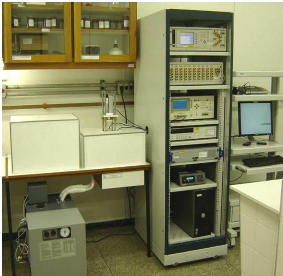
**Figura 9** - Sistema Primário de Medição de Condutividade Eletrolítica do Inmetro.
