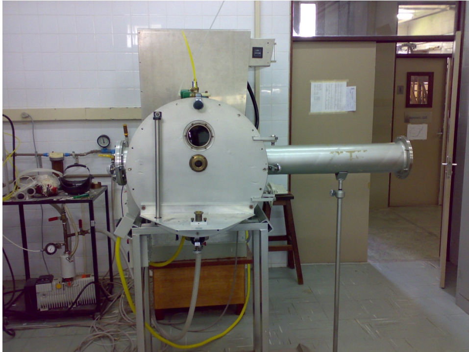
Figura 38 – Equipamento utilizado, na UFPE, para produção de amostras GMI pela técnica “Single Roller Melt Spinning”.
