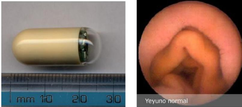
Figuras 22 e 23 - modelo de cápsula endoscópica e exemplo de fotografia que pode ser tirada com o dispositivo.
