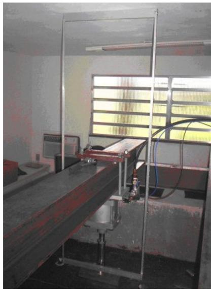
Figura 3.25: Ensaio por cisalhamento com a placa metálica retangular (área de 450 cm<sup>2</sup>)
