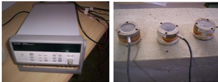
Figura 3.7: Sistema de aquisição de dados e células de carga utilizadas no Tanque – Teste
