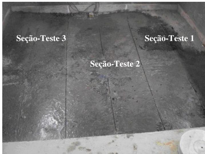
Figura 3.12: Configuração das três seções-teste e das trincas produzidas de modo artificial
