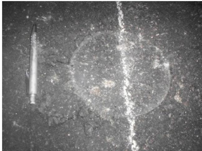
Figura 3.21: Local do ensaio (FL3) em que foi observada apenas ruptura localizada do revestimento asfáltico
