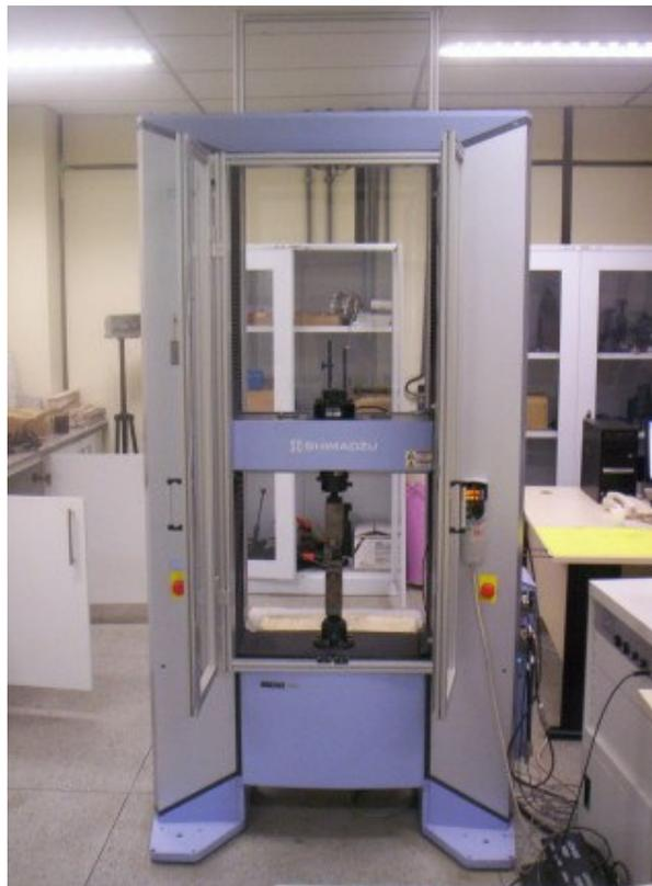
Figura 3.45: Prensa utilizada para realização dos ensaios no Laboratório de Estruturas da COPPE/UFRJ.
