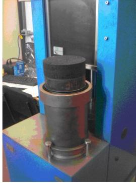
Figura 3.33: Corpos de prova após conclusão da compactação neste estudo
