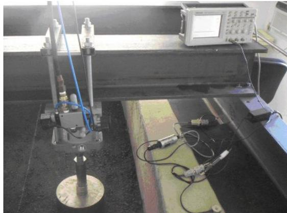
Figura 3.22: Calibração do novo cilindro de carga no tanque – teste neste estudo
