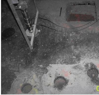
Figura 3.13: Locais em que foram extraídos materiais do pavimento experimental
