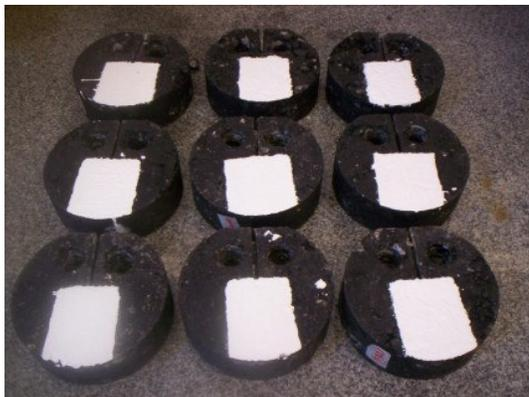
Figura 3.40: Corpos de prova moldados com pintura branca na provável região de propagação da trinca
