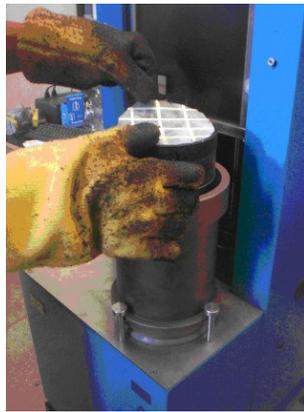
Figura 3.31: Colocação da camada intermediária (no caso apenas como ilustração, é mostrada a geogrelha de fibra de vidro utilizada)
