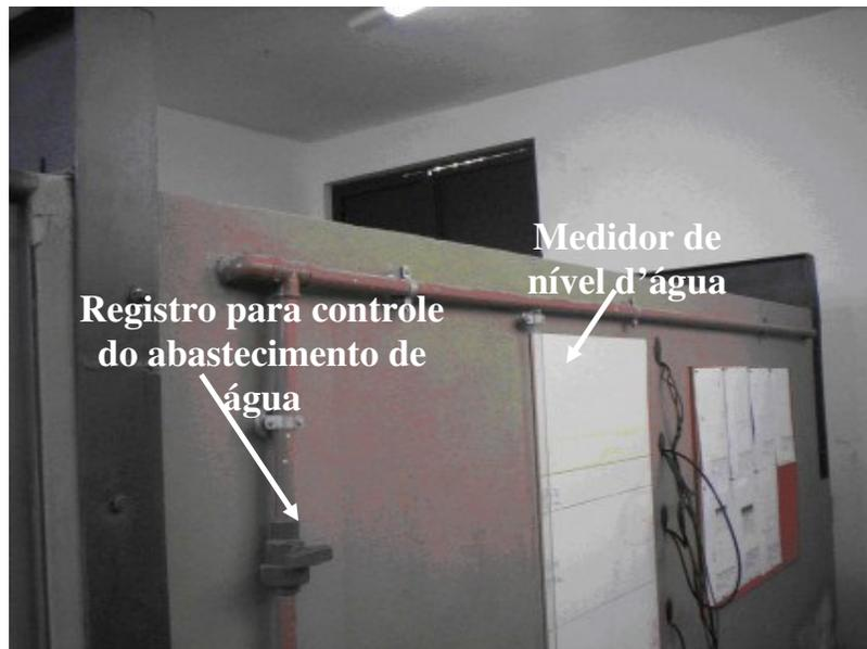
Figura 3.3: Medidor de nível d'água e tubulação para abastecimento de água no interior do tanque
