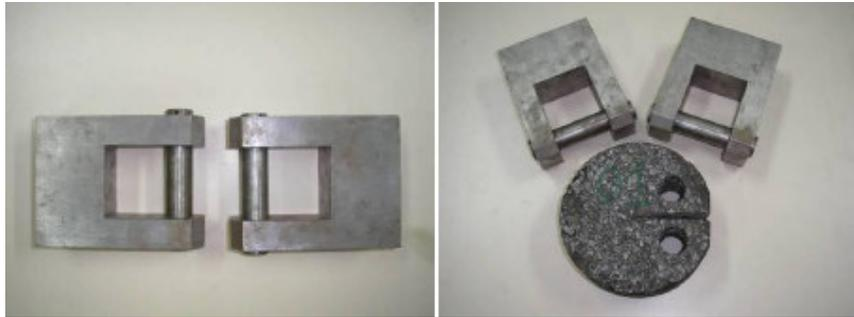
Figura 3.44: Garras utilizadas para fixação do corpo de prova na prensa de carregamento do ensaio (HIRSCH, 2009).
