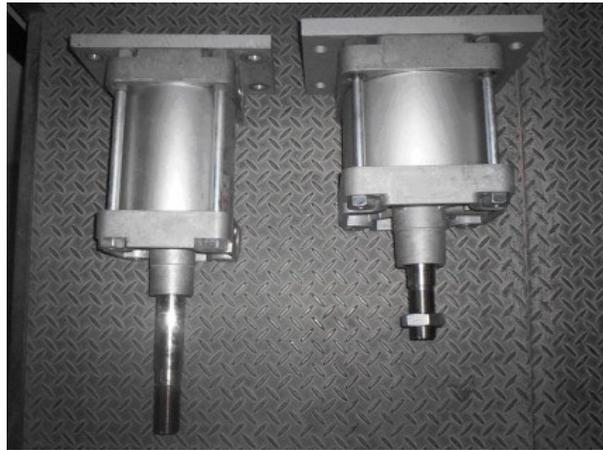
Figura 3.18: Cilindros de carga utilizados nesta pesquisa (êmbolo: 160 mm e 200 mm)
