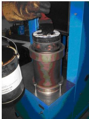
Figura 3.32: Reaplicação de emulsão asfáltica sobre a geogrelha
