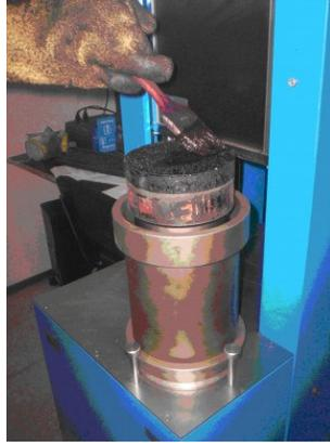
Figura 3.30: Aplicação de emulsão asfáltica na primeira metade do corpo de prova moldado
