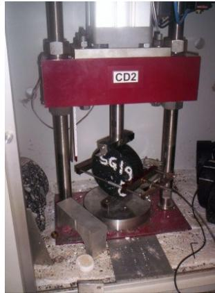
Figura 3.35: Equipamento e execução de ensaio de Módulo de Resiliência na COPPE.
