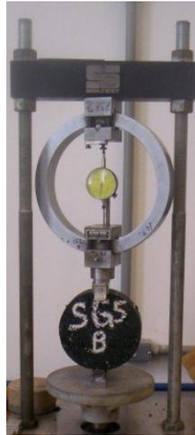
Figura 3.36: Equipamento e ensaio de resistência à tração estática.
