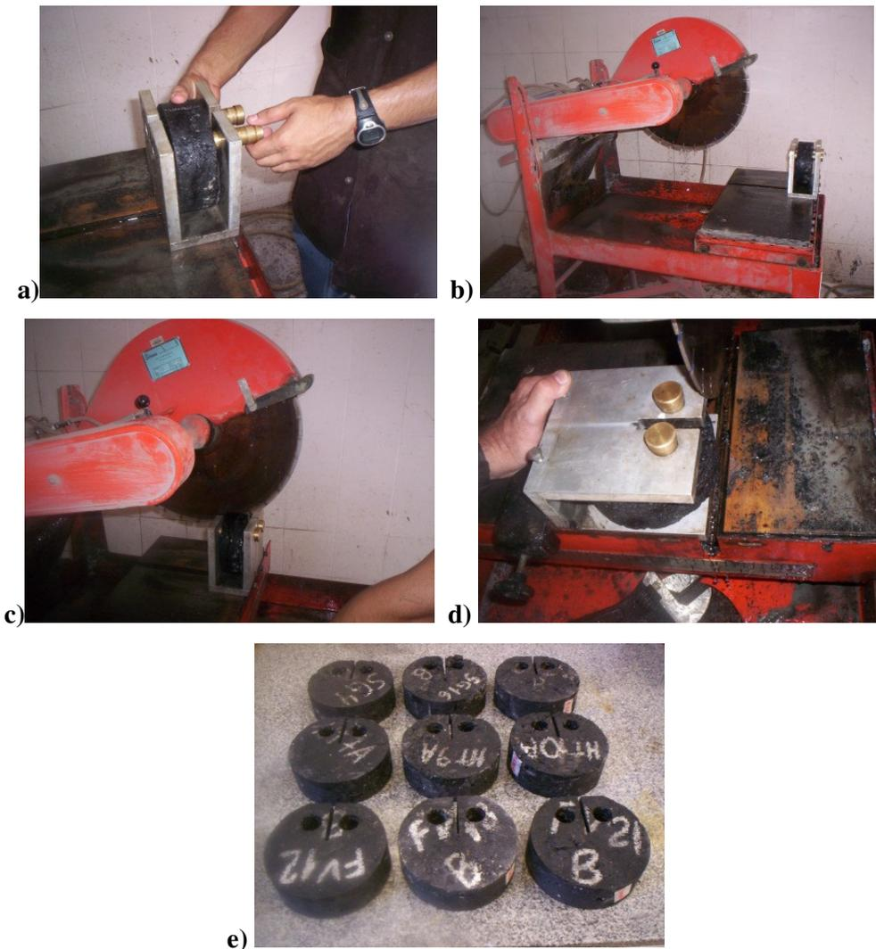
Figura 3.39: Execução da pré-trinca e do chanfro nos corpos de prova para ensaio de tração: a) fixação gabarito metálico; b) posicionamento no equipamento de corte; c) execução da pré-trinca; d) execução do chanfro e) configuração para ensaio de tração em disco circular com fenda.
