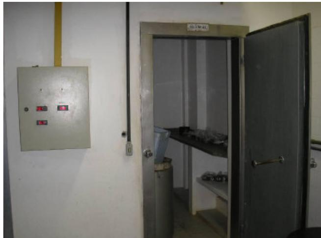
Figura 3.42: Câmara de condicionamento de temperatura das amostras utilizadas (HIRSCH, 2009).
