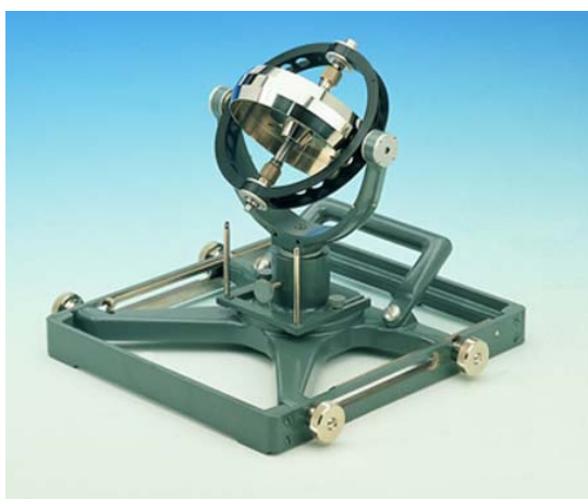
Figura 2.1: Giroscópio de Magnus (Phywe.com)
