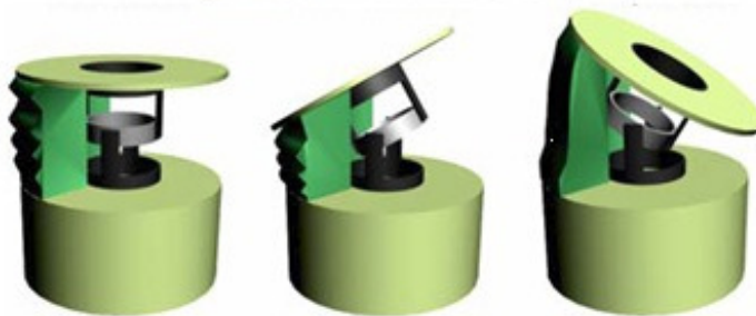
Figura 6 – Estrutura Baseada em Juntas Pneumáticas
