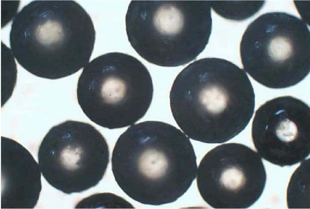
Figura 4.30 – Microscopia óptica das microesferas de vidro tamanho #20/40 com cobertura de 1% de resina.
