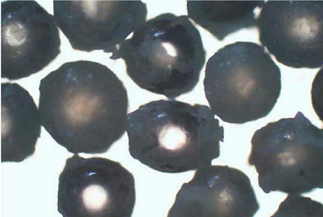
Figura 4.32 – Microscopia óptica das microesferas de vidro tamanho #20/40 com cobertura de 8% de resina.
