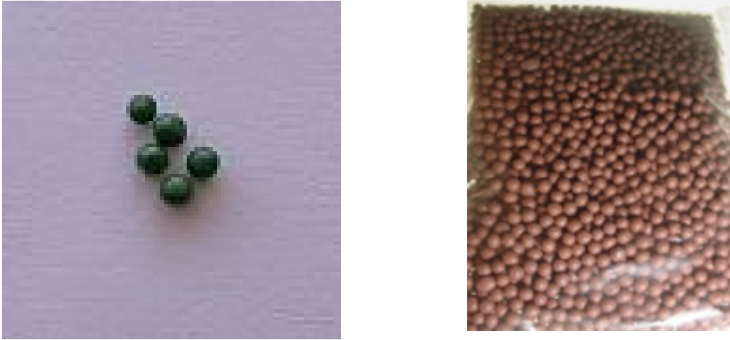
Figura 4.13 – Variedade de miçangas do tipo maciça (bolinha sem furo) usadas nos testes.
