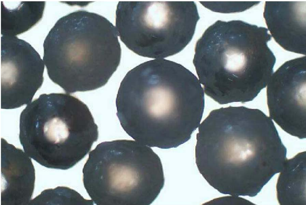
Figura 4.31 – Microscopia óptica das microesferas de vidro tamanho #20/40 com cobertura de 4% de resina.
