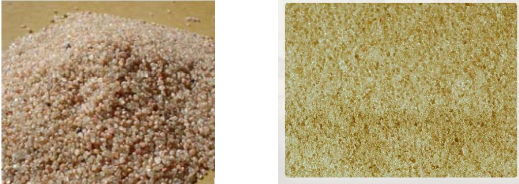
Figura 2.9: Areia resinada tamanho # 20x40. Em (a) imagem em tamanho normal mostrando os grãos de areia resinados; em (b) microscopia ótica com aumento de 50 X mostrando detalhes superficiais dos grãos resinados. (Fonte: www.mjundu.com.br )
