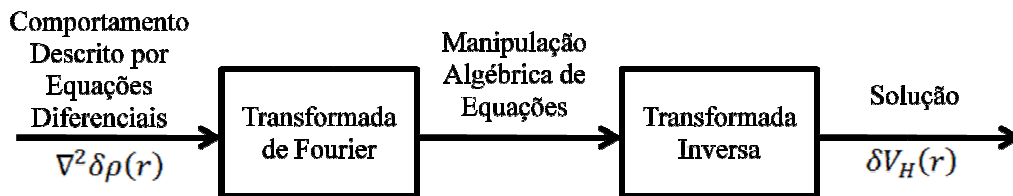
Figura 26 – As equações diferenciais são transformadas em equações algébricas.
