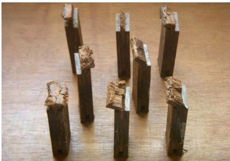
Figura 33- Corpos de prova que não romperam na linha de cola com espessura de 3mm
