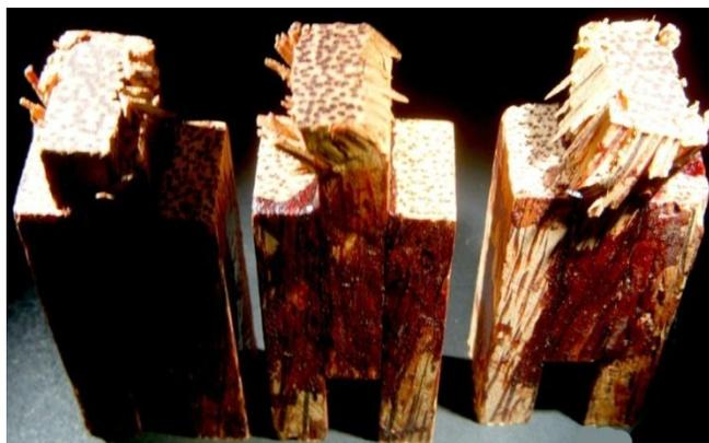
Figura 34 Amostras de coqueiro com espessura de 10mm que não resistiram ao ensaio de cisalhamento na linha de cola.
