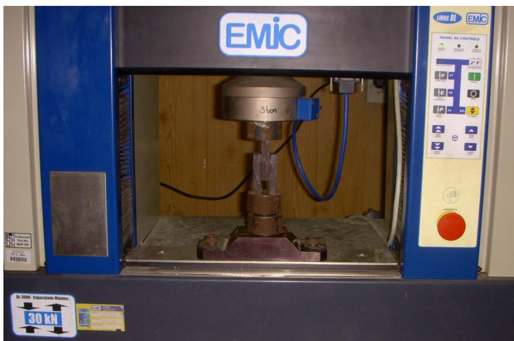
Figura 14 - Corpo de prova posicionado para realização do ensaio de cisalhamento na linha de cola na máquina de ensaio.
