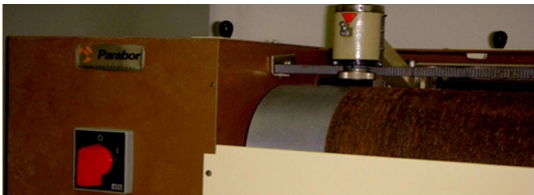
Figura 15 - Abrasímetro AP-40 utilizado.
