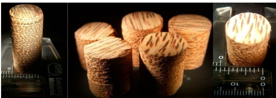
Figura 16 - Corpos de prova do ensaio de abrasão
