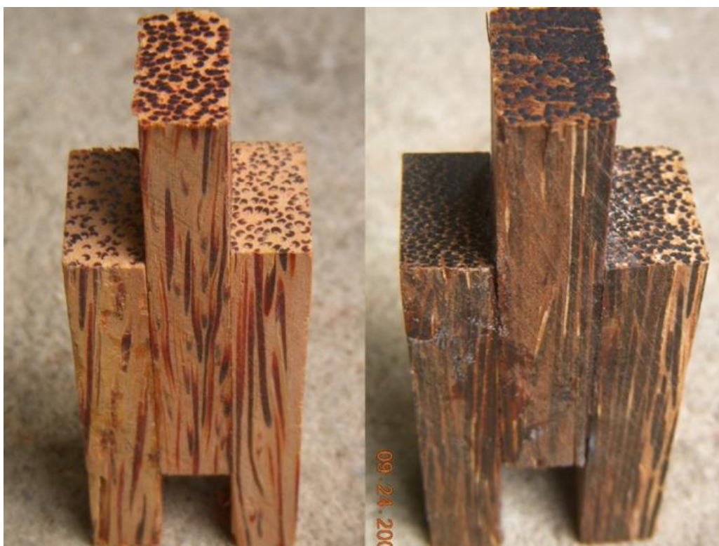
Figura 13 - Corpos de prova de coqueiro e pupunha, respectivamente, usados no ensaio de cisalhamento na linha de cola.
