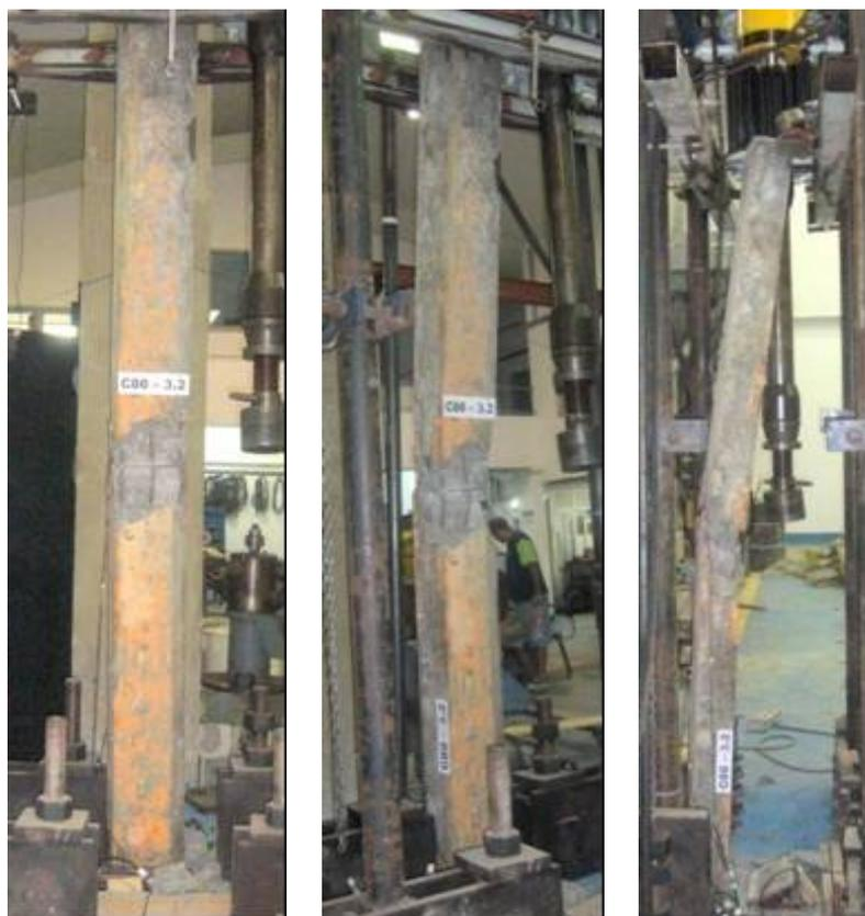
Figura 4.7 – Ensaio do pilar C80-3.2
