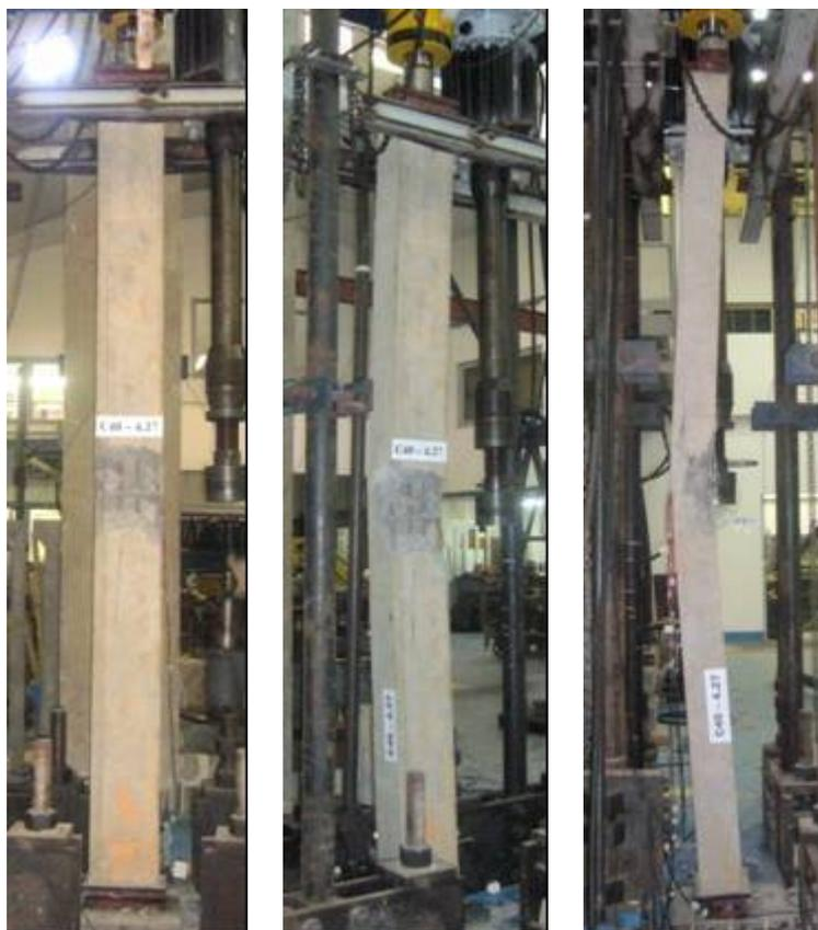
Figura 4.4 – Ensaio do pilar C40-4.3
