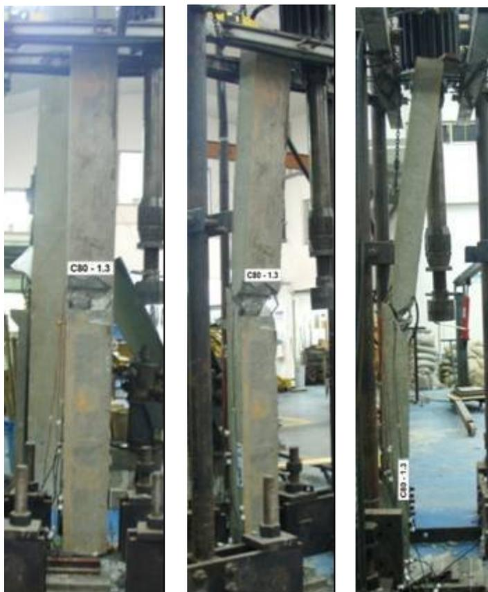
Figura 4.5 – Ensaio do pilar C80-1.3
