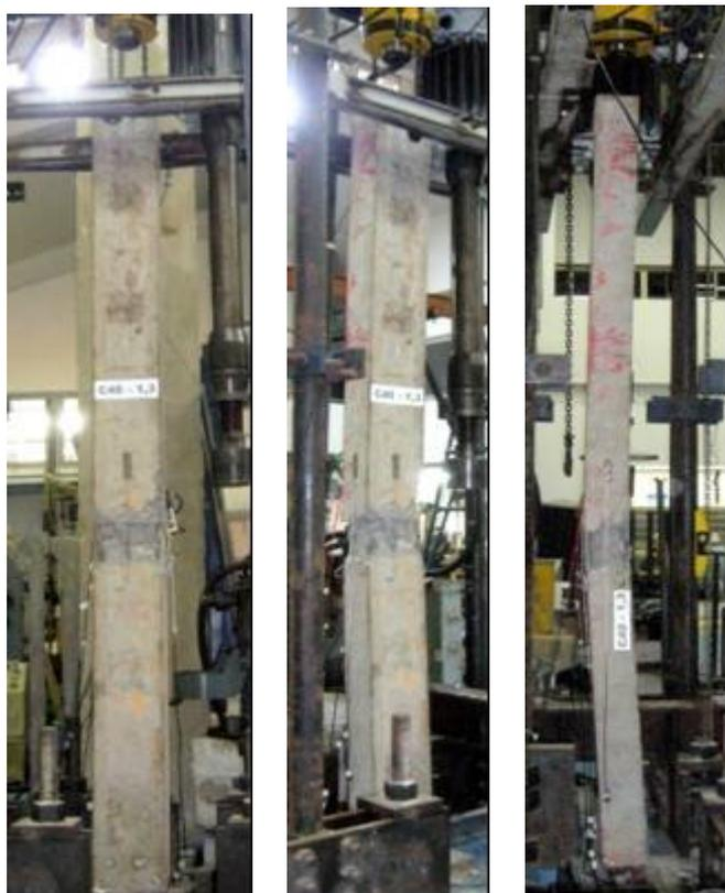
Figura 4.1 – Ensaio do pilar C40-1.3
