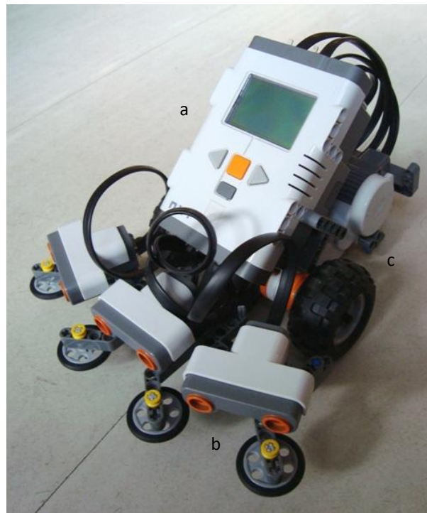
Figura 4.13: Robô Lego MindStorms NXT montado para avaliação prática do modelo RL-NFHP, constituído por: (a) brick NXT; (b) 3 sensores ultrassônicos; (c) 2 servo-motores.
