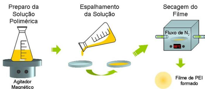
Figura 3.6: Esquema do processo de fabricação dos filmes de PEI.
