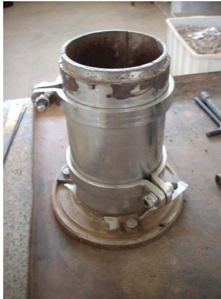
Figura 3.13. Molde tripartido 10 x 20 cm, para compactação de corpos de prova.
