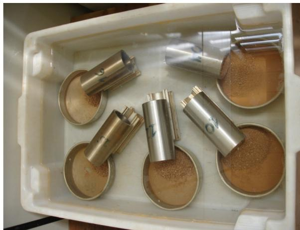
Figura 3.10. Perda por imersão do solo deste estudo após 20 horas de imersão.
