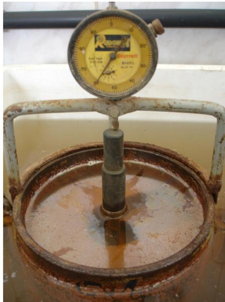
Figura 3.16. Tomada de leitura de deformação no ensaio CBR na amostra desta pesquisa.
