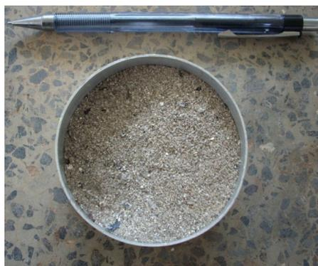
Figura 3.2. Cinza Volante de RSU.
