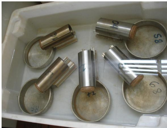
Figura 3.9. Cápsulas imersas para o ensaio imediatamente após imersão.
