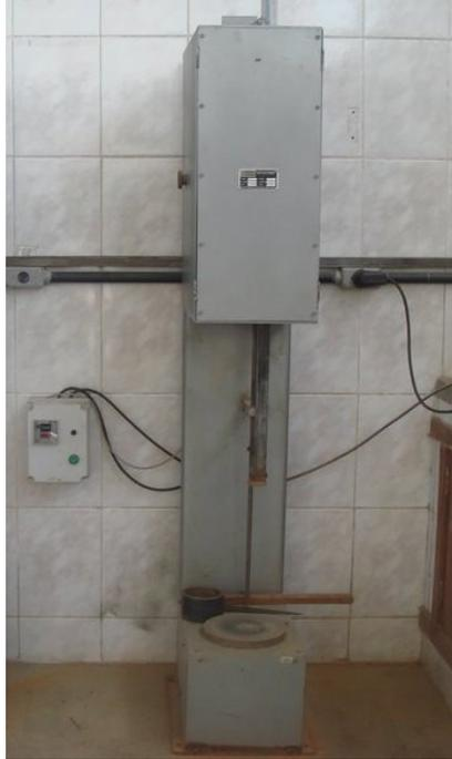
Figura 3.12. Equipamento mecânico para compactação de corpos de prova.
