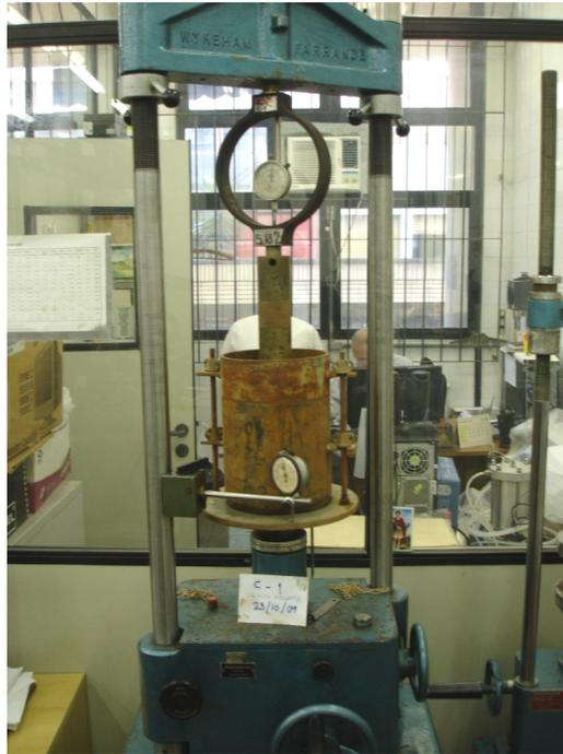
Figura 3.17. Fotografia do Equipamento utilizado para obtenção do CBR nesta pesquisa.
