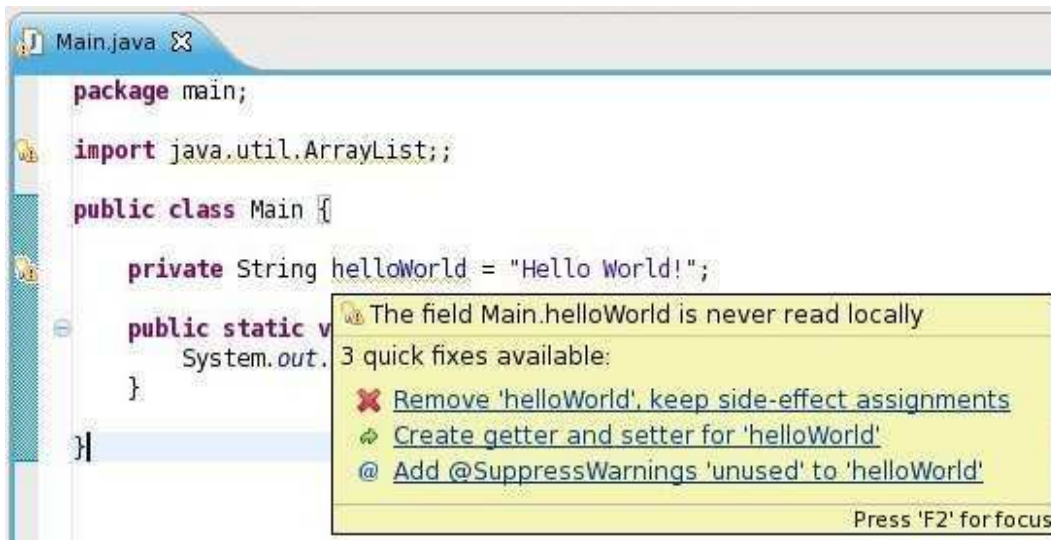
Figura 3.2: Crítica proveniente do compilador, informando que uma variável declarada não está sendo usada.
