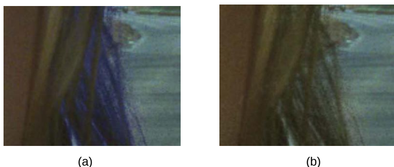
Figura 3.5 Processo de despill no software Keylight. A imagem (a) apresenta o vazamento no cabelo do ator e a imagem (b) apresenta o resultado do despill.
