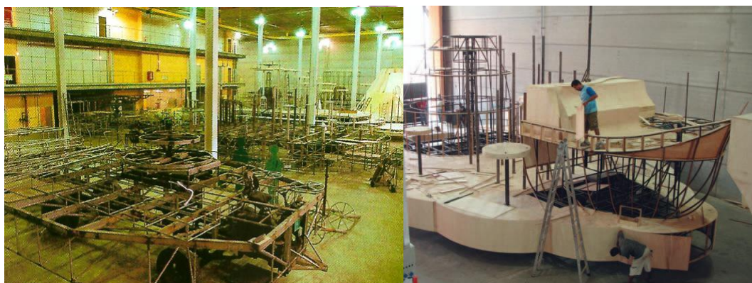
Figuras 16 e 17 – Fotos de alegorias em seus estágios iniciais: primeiro, a ferragem; depois, a marcenaria começa a dar forma. Fonte: http://liesa.globo.com/
