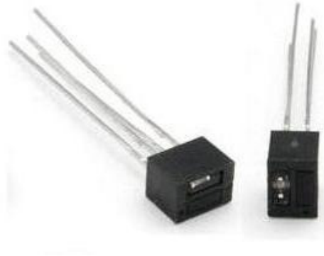
Figura 35 – Sensor infravermelho utilizado. QRD1114 – FairChild Semiconductors . [19]
