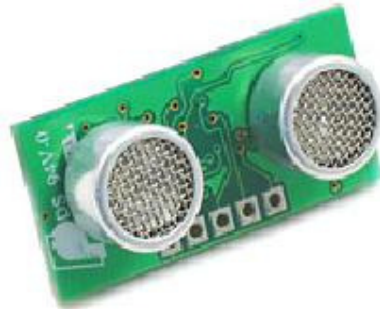
Figura 34 – Sensor ultrassônico utilizado. Modelo SRF10.
