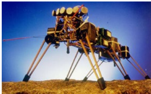
Figura 3 - Robô inseto Genghis I controlado por comportamento. (BROOKS, 1999) [16]
