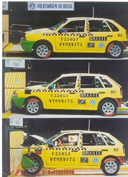
Figura 17 - Etapas de um crash em VW Gol segundo FMVSS 208. Fonte: http://www.estradas.com.br/new/materias/materia_air_bags.asp
