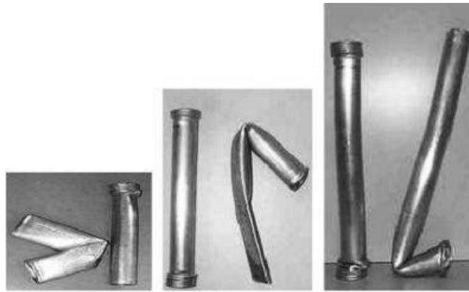
Figura 27(a), (b) e (c) - Diferença na flambagem global de elementos de seção tubular. Fonte: (Karagiozova; Alves, 2004).
