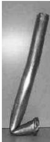
Figura 26 – Flambagem global de elementos de seção tubular. Fonte: (Jones, 1997).
