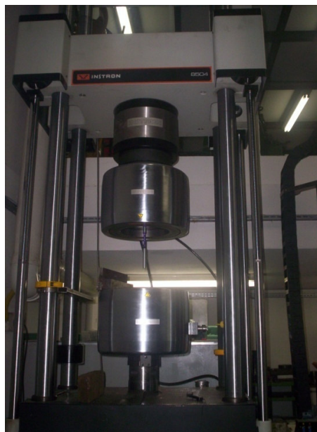
Figura 15 – Máquina hidráulica para ensaios de materiais – Fonte: ITUC – PUC-RJ.
