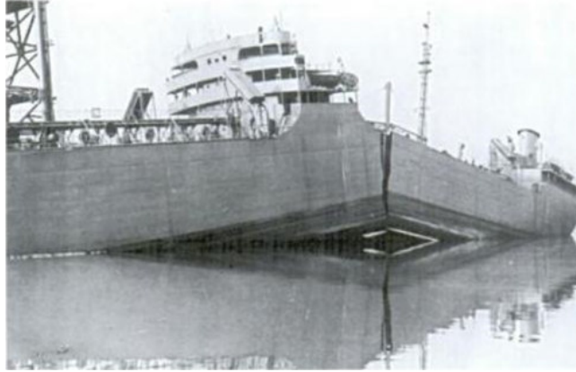
Figura 13 – Navio Liberty partido em dois após falha repentina (frágil) resultante de carregamento dinâmico de baixo grau significativo. Fonte: (Norton, 2000).
