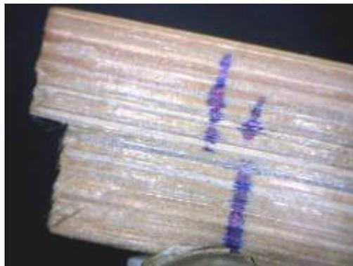
Figura 9- Deslocamento nos extremos do corpo-de-prova.
