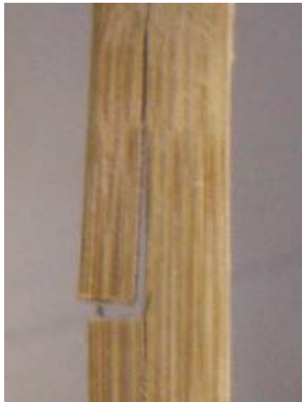
Figura 13- Detalhe do modo de propagação da fissura num ensaio de tração simples para a determinação do fator de intensidade de tensões.
