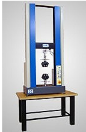
Figura 6- Máquina de ensaios EMIC DC3000.
