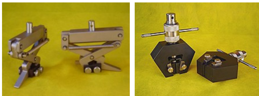
Figura 9- Garras. (a) por efeito de alavanca. (b) por efeito cunha.
