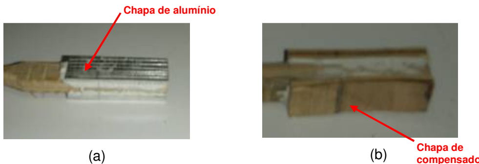
Figura 3-Detalhe do tratamento das extremidades dos corpos-de-prova para evitar o deslocamento com as garras durante o ensaio de tração. (a) Espécime com chapa de alumínio. (b) Espécime com chapa de compensado.
