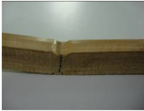
Figura 16- Esmagamento ocorrido no ensaio de flexão.
