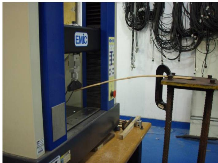
Figura 3-3 - Finalização do ensaio para a determinação do módulo de elasticidade à flexão
