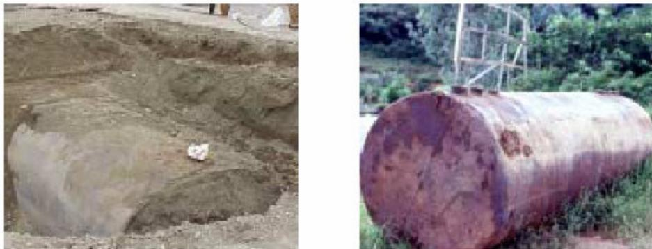
Figura 1 – Tanques de gasolina com problemas de corrosão (Mainier & Leta, 2001).
