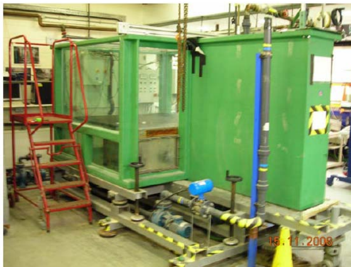
Figura 4 - Tanque T usado numa primeira validação das equações de correntes de densidade (Bitton, 2008)
