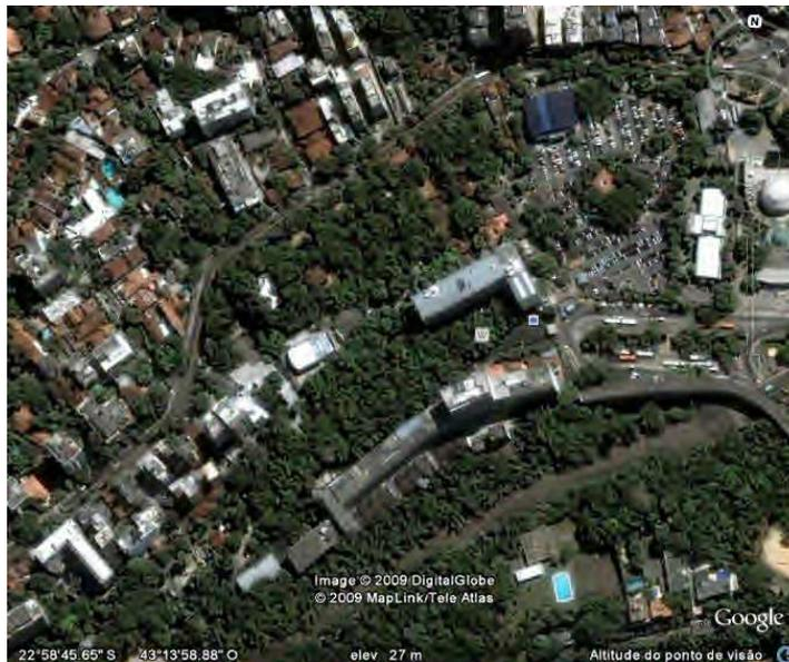
Figura 5.20: Imagem PUC comprimida com SPIHT 0.5 bpp e recuperada depois de passar por um canal AWGN com  $E_b/N_0 = 6\text{dB}$ , usando LT-Hamming para controle de erro,  $PSNR = 21,55\text{ dB}$ .
