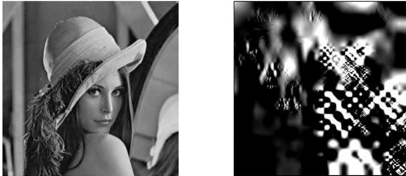
Figura 2.2: Lena  $256 \times 256$  comprimida com SPIHT logo de que o *bitstream* atravessa um canal AWGN com  $E_b/N_o = 6dB$  a imagem é descomprimida, na imagem da direita os erros ocorrem no início do bitstream.
