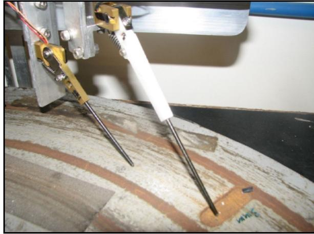
Figura 22 - Foto dos sensores palito no disco giratório
