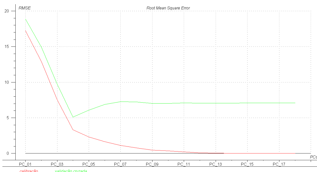
Figura 98 - Gráfico RMSEP versus o número de componentes principais, do modelo PLS construído para a determinação de 9MA ( \Delta\lambda = 120 \text{ nm} , 340 – 400nm).
