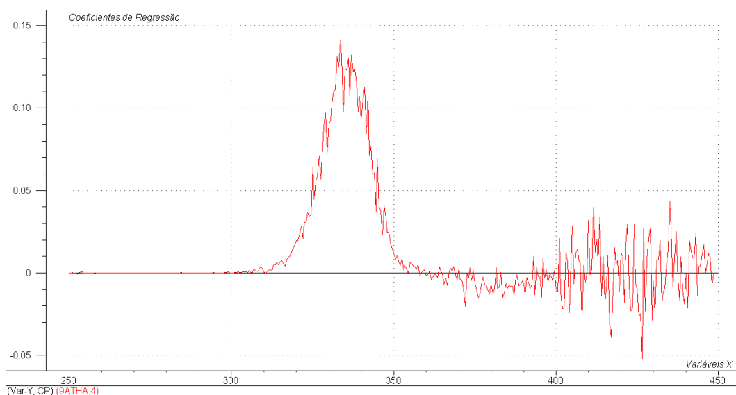
Figura 88 - Coeficientes de regressão do modelo PLS construído com os espectros inteiros (250 a 450 nm) de varredura sincronizada, \Delta\lambda = 30\text{nm} , das misturas do conjunto calibração para a predição de 9ATHA.
