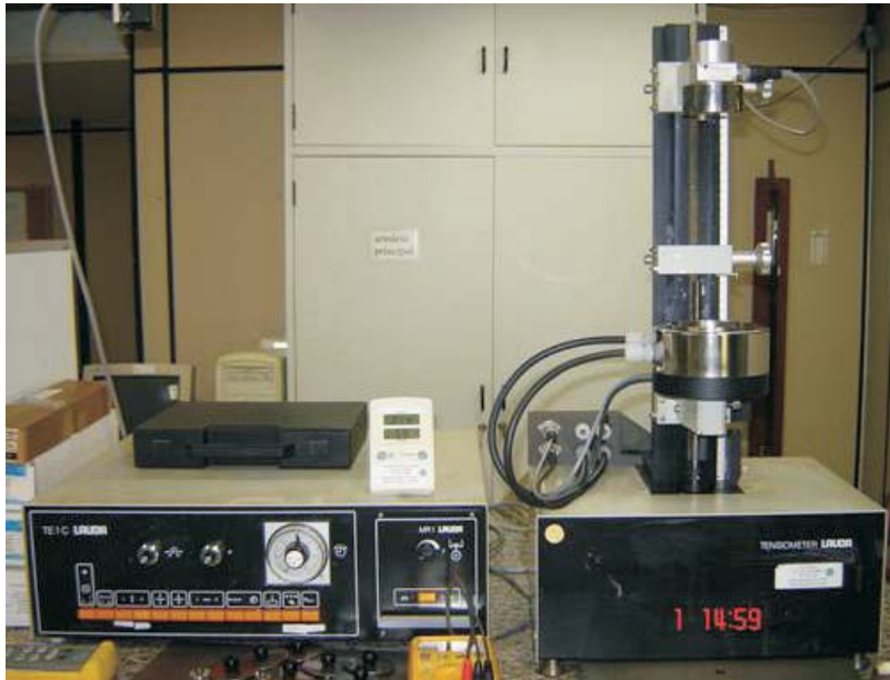
Figura 5.3: Tensiômetro usado para medição de tensão superficial. Foto tomada do trabalho de Del Aguila [2](2008)
