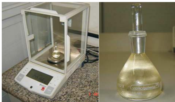
Figura 5.2: Picnômetro e balança utilizada para a medição de densidade. Foto tomada do trabalho de Del Aguila [2](2008)
