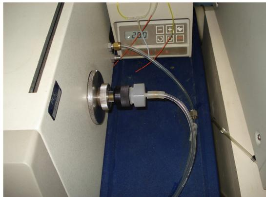
Figura 4.7. Conexão da saída do laser para o tubo injetor do ICPMS.
