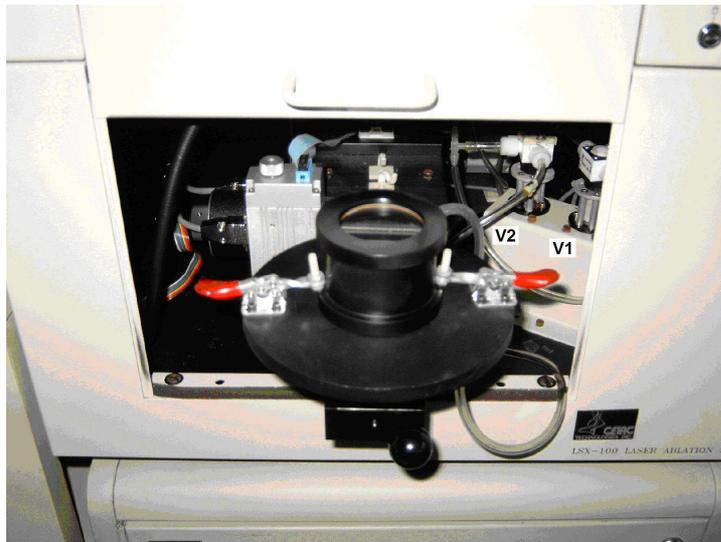
Figura 4.6. Detalhes da câmara de ablação mostrando ainda as válvulas de entrada de gases (V1 = purga, V2 = carreador).
