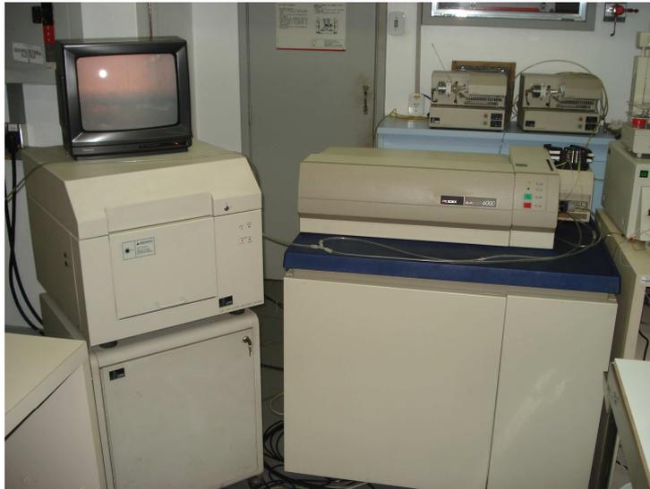
Figura 4.5. Laser Cetac LSX 100 e ICPMS ELAN 6000 (PerkinElmer-Sciex) no Laboratório da PUC-Rio e utilizados neste trabalho.
