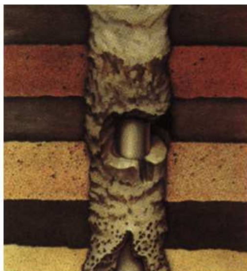
Figura 1.3 - Falha na Operação de Cimentação [1]
