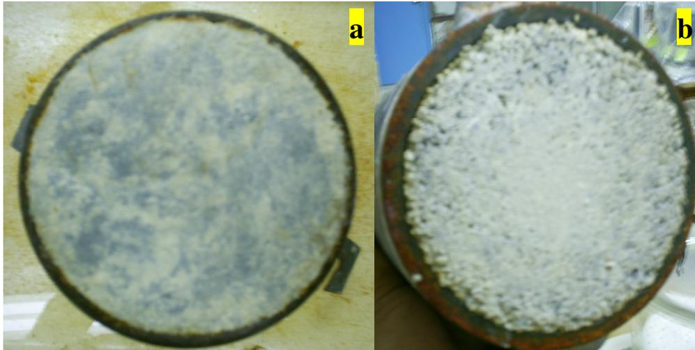
Figura 5.3 Morfologia de amostras moldadas a diferentes umidades (a:195% e b:72%)
