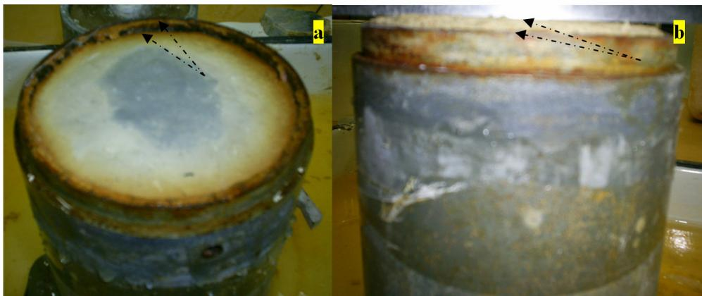
Figura 5.4 - Variações de volume no ensaio de permeabilidade: a) recalque b) expansão
