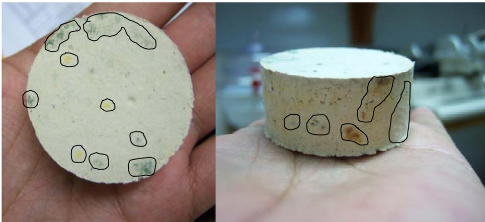
Figura 4.6 - Fungos após selagem por quatro dias da amostra compactada a 125% de umidade.
