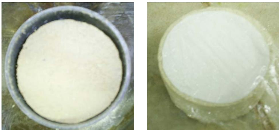
Figura 4.3 - Redução da área de contato do papel de filtro devido à contração do resíduo.
