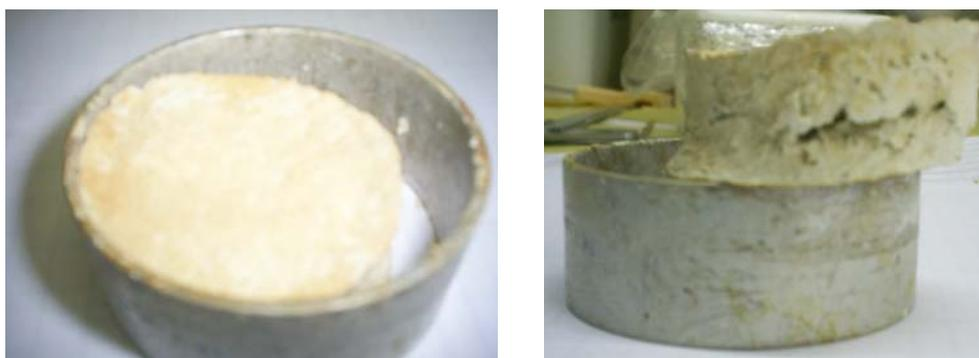
Figura 4.5 - Ruptura do espécime pelas forças de tração geradas nas bordas RIP/molde.
