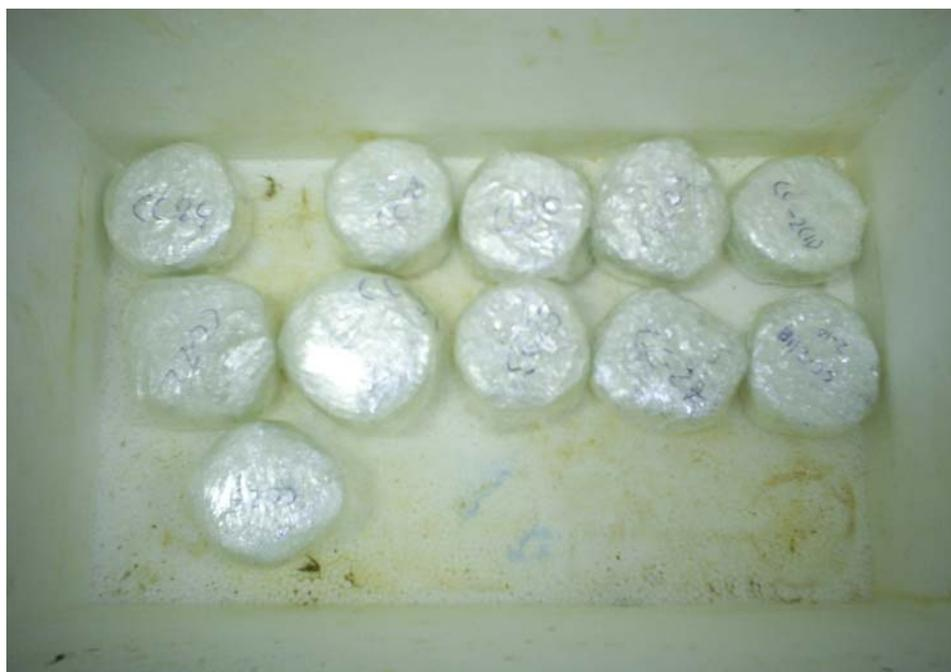
Figura 4.1 - Armazenagem das amostras de RIP na técnica de papel de filtro.
