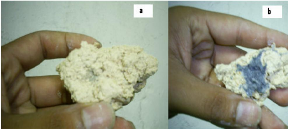
Figura 3.5 - Diferença das estruturas do RIP compactado a distintas umidades.
