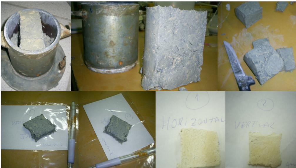
Figura 2.1 - Procedimento de preparação das amostras para o MEV.
