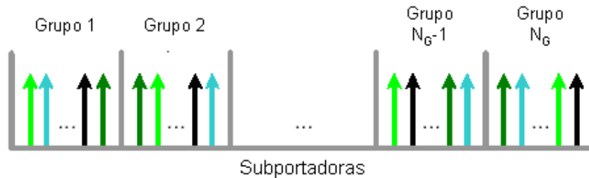
Figura 1.5: Subportadoras OFDMA no domínio da frequência.
