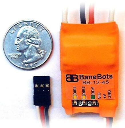
**Figura 26 - Controlador de Velocidade *Banebots***
