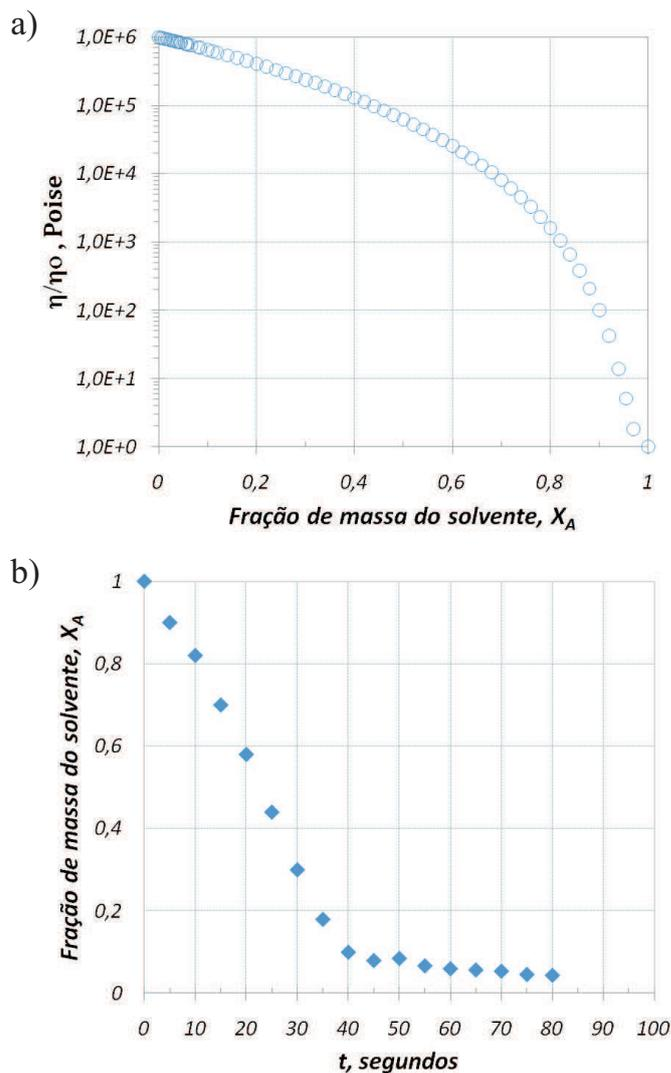
Figura 5.1: a) Viscosidade em função da concentração de massa do solvente. b) Variação da fração de massa de um sistema com solvente volátil (tolueno) obtida por Drike & Wang [69].
