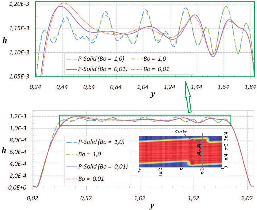
Figura 5.5: Perfis de espessura obtidos para os casos  $Bo = 1,0$  e  $Bo = 0,01$  para  $t = 1,6 \times 10^3$ . Comparação do caso base sem considerar solidificação e os casos obtidos neste capítulo, para os mesmos parâmetros de operação.
