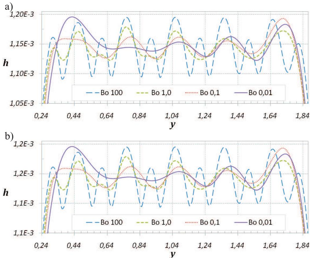
Figura 5.4: Gráfico do perfil da espessura do filme depositado em  $\theta = \pi/2$  (Corte (A-A)): a) no instante no qual a porta de injeção atinge a distância final axial. b) No seguinte intervalo de tempo  $t$  com o cilindro estacionário.
