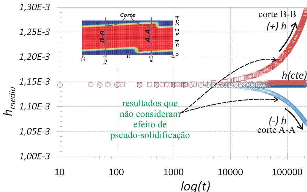
Figura 5.7: Comparação da espessura média ao longo do tempo, medida em  $\theta = \pi/2$  e  $\theta = 3\pi/2$  para  $Bo = 1,0$ , obtidas pela análise do capítulo 4 e 5.
