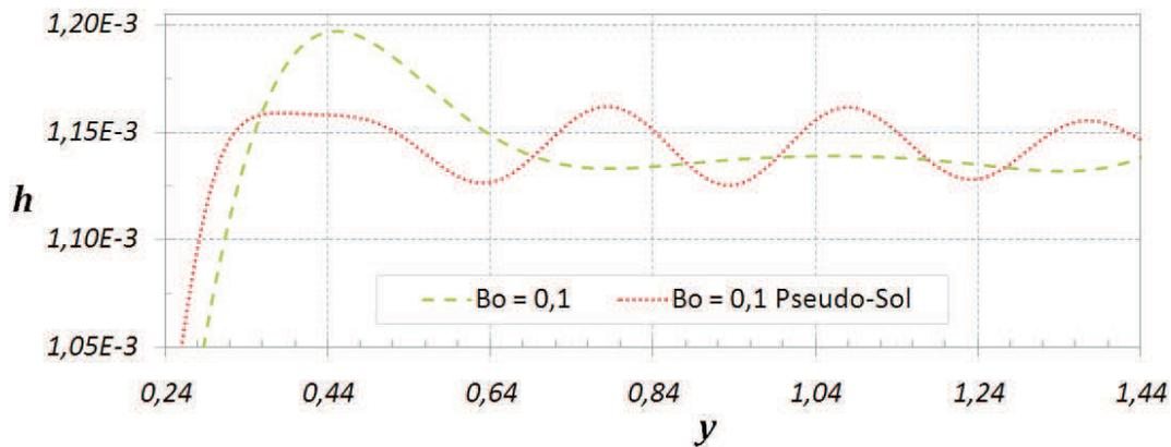
Figura 5.6: Comparação dos perfis de espessura obtidos em  $t = 1,45 \times 10^4$  medida em  $\theta = \pi/2$ . Com pseudo-solidificação representada com linha tracejada e sem pseudo-solidificação com linha pontilhada.
