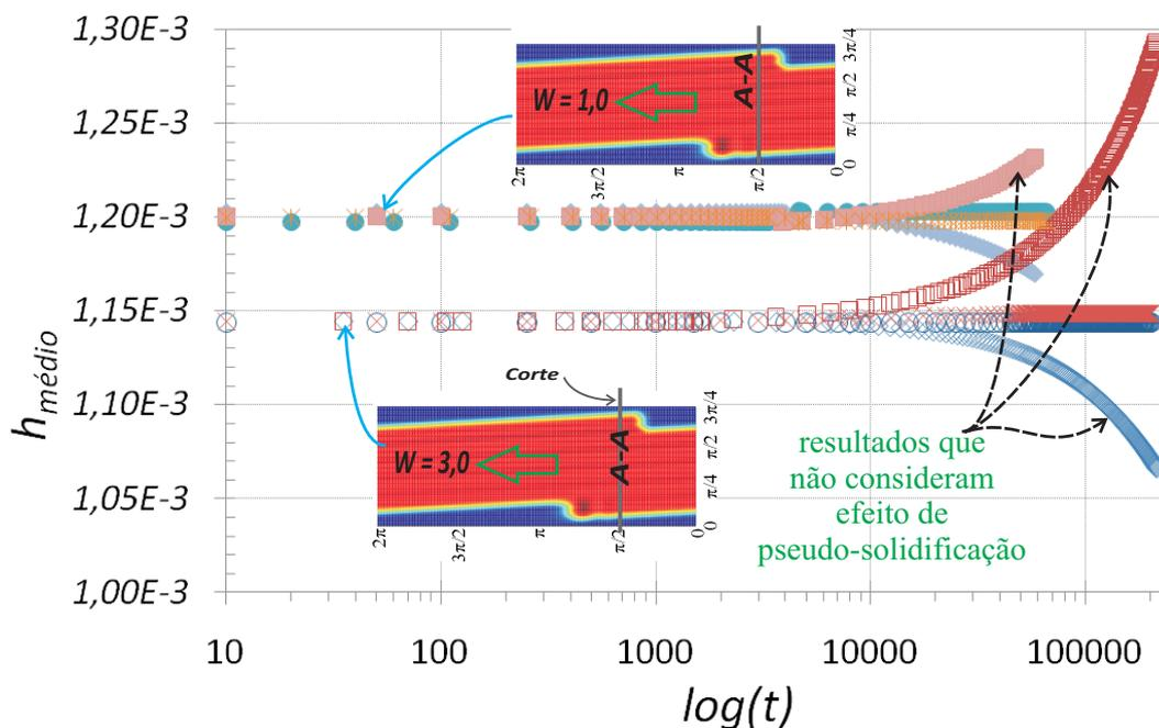
Figura 5.8: Espessura média ao longo do tempo, medida em  $\theta = \pi/2$  e  $\theta = 3\pi/2$  para  $Bo = 1,0$ . Com  $W = 1,0$  (superior) e com  $W = 3,0$  (inferior).
