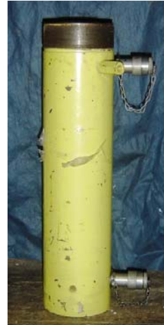
Atuador hidráulico ENERPAC. Capacidade de 300kN.
