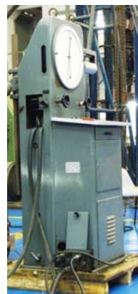
Bomba hidráulica de pressão controlada AMSLER. Figura D.2 – Bomba hidráulica de pressão controlada.
