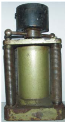
Atuador hidráulico EMIC. Capacidade de 100kN.
