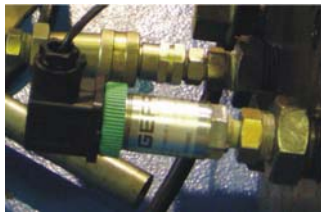
Transdutor de pressão GEFran Modelo TK-N-1-E-B03C-M-V Capacidade de 300 bar
