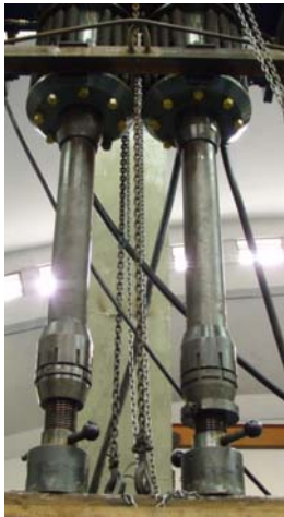
Atuador hidráulico AMSLER. Capacidade de 1000kN. Figura D.1 – Atuador hidráulico.
