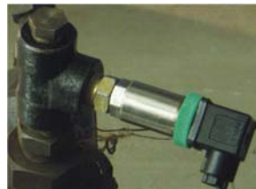
Transdutor de pressão GEFran Modelo TK-N-1-E-B04C-M-V Capacidade de 400 bar
