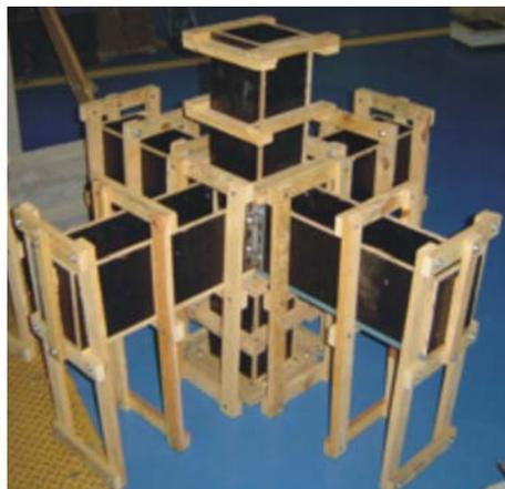
(c) Pilar com viga nas duas direções
