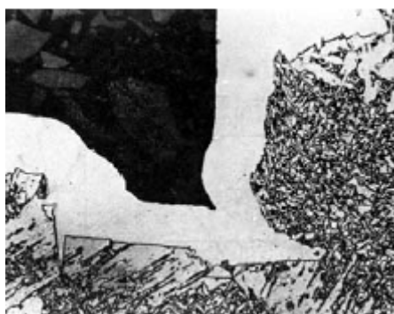
Figura 12-Trinca propagando pela ferrita de segunda fase (FS(A)), imobilizada pela ferrita acicular [10].
