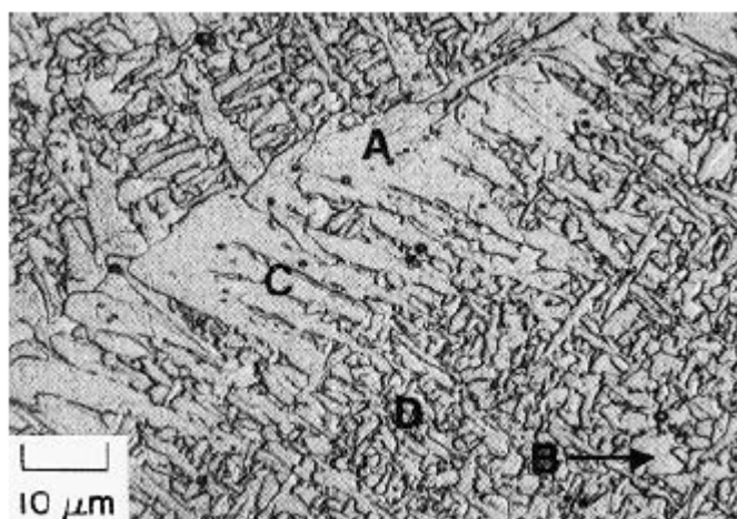
Figura 9- Micrografia mostrando a microestrutura típica de aços baixo C: A- Ferrita de Contorno de grão; B- Ferrita Poligonal; C- Ferrita de Widmanstätten; D- Ferrita Acicular [13].
