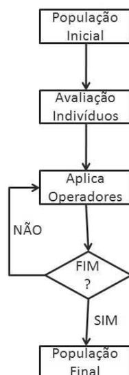
Figura 7.3: Fluxograma da otimização de agregados atômicos e moleculares.
