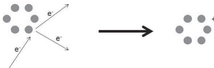
Figura 7.9: Formação de agregados de água positivos através da perda de um elétron.
