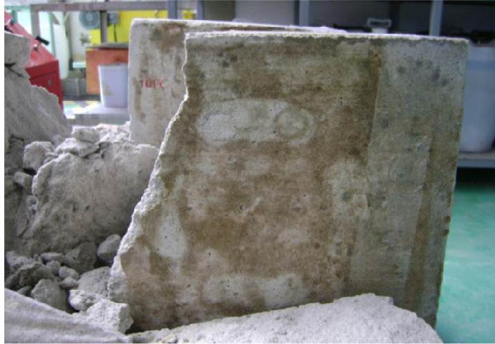
Figura 6.1 – Forma de ruptura típica do ensaio realizado.
