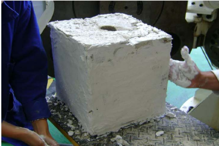
Figura 5.30 – Corpo de prova sendo preparado para colocação da resina
