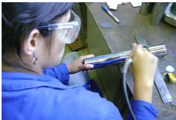
Figura 5.22 – Preparação dos tubos para colagem dos medidores de deformação.
