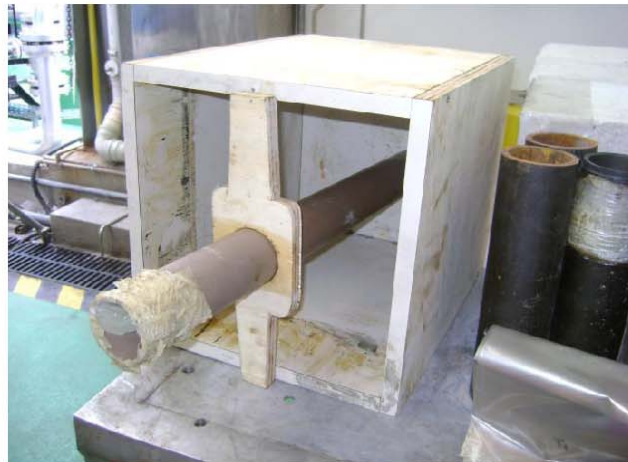
Figura 5.8 – Forma utilizada para moldar os blocos da segunda fase.
