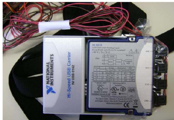
Figura 5.20 – Equipamento utilizado para leitura dos medidores de deformação.
