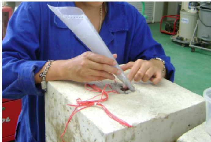
Figura 5.34 – Instalação do sistema gravel-tela .
