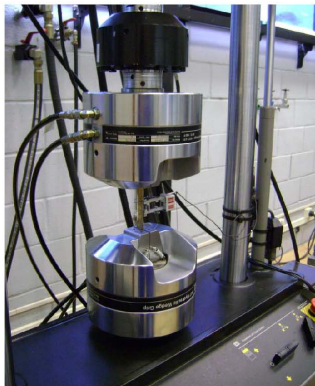
Figura 5.13 – Ensaio de tração do latão.
