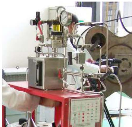
Figura 5.4 – Sistema de válvulas secundário.
