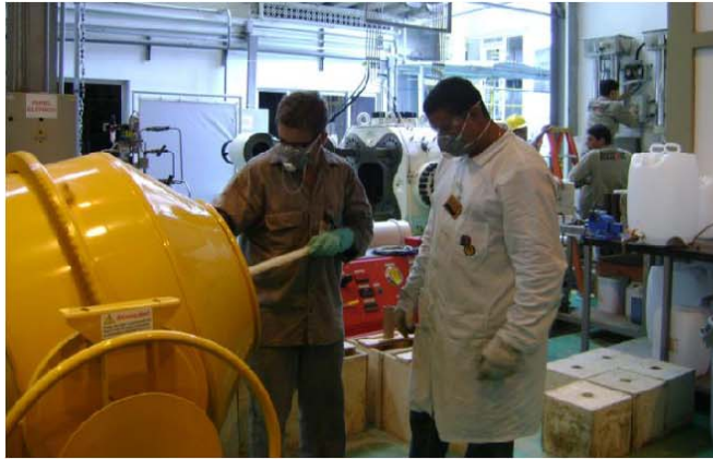
Figura 5.10 – Confeção dos blocos (mistura).
