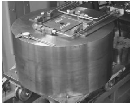
Figura 4.1 – Célula biaxial (Haimson e Lee, 2004).
