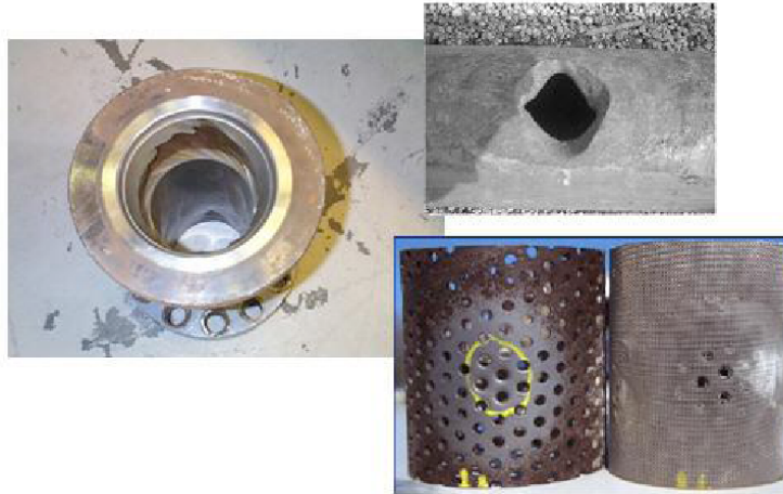
Figura 2.1 – Equipamentos internos erodidos pelo carreamento de grãos.
