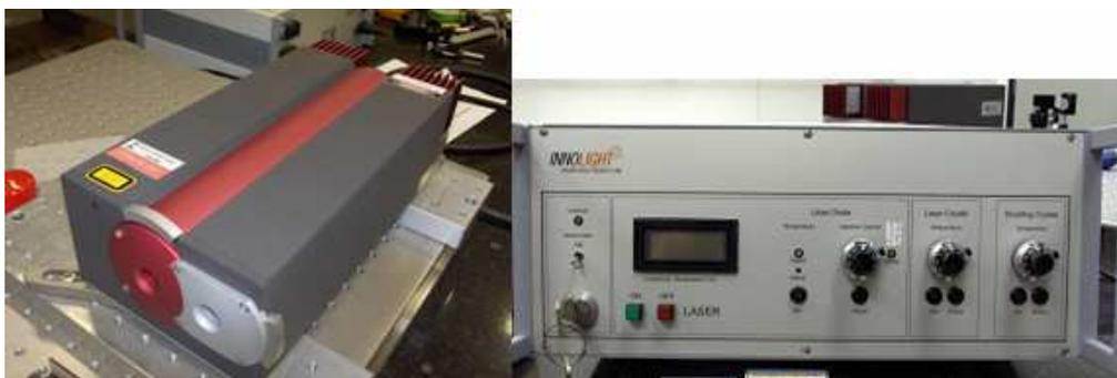
Figura 3.2. Sistema Laser Nd:YAG: (a) Cabeça do laser, (b) Unidade de controle eletrônico [28].
